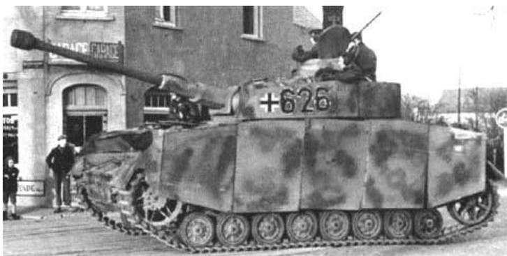
A origem desta idéia remonta à segunda guerra mundial onde foram largamente usados pelos alemães uma proteção em telas, chapa metálicas ao redor dos blindados, evitando desta forma que suas blindagens fossem penetradas por munição de carga oca, o que deu bons resultados.
