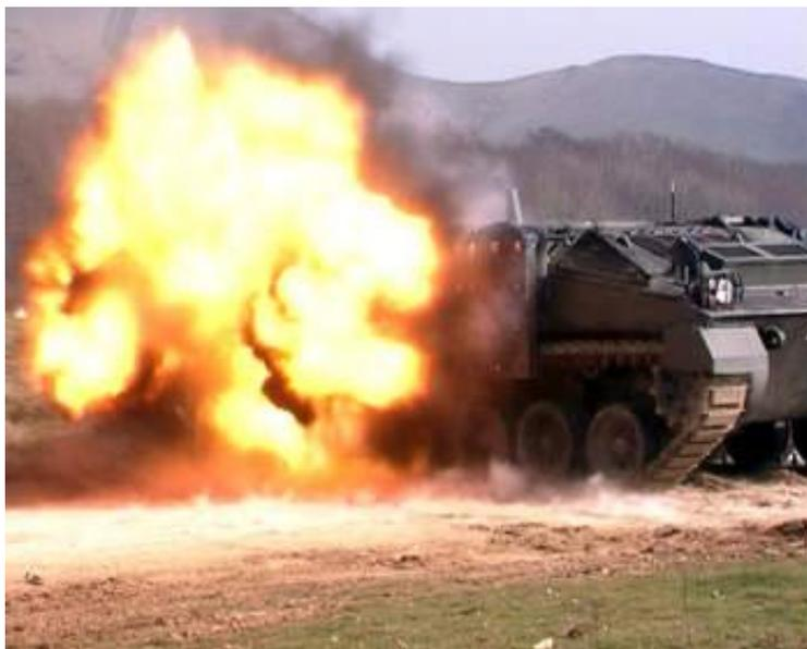
Teste da blindagem elétrica, realizado em 2003, na Inglaterra, instalada na lateral de um veículo transporte de tropas FV-432.
