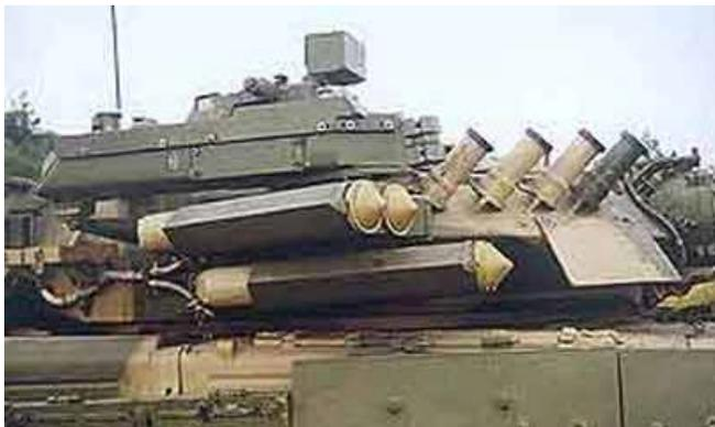
Sistema DROZD instalado num carro de combate. Abaixo e à esquerda dos lançadores fumíginos, ao lado. Abaixo: Diagrama do funcionamento deste sistema.
