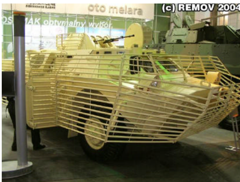
Veículo blindado 4x4 BRDM JACKAL 2M96iK + com a nova blindagem “gaiola” e camuflagem típica para deserto, apresentado pelo WZM na 12ª Exposição Internacional de Material de Defesa (MSPO) na Polônia, no período de 30 de agosto a 02 de setembro de 2004. Crédito da foto: Militaryphotos.net
