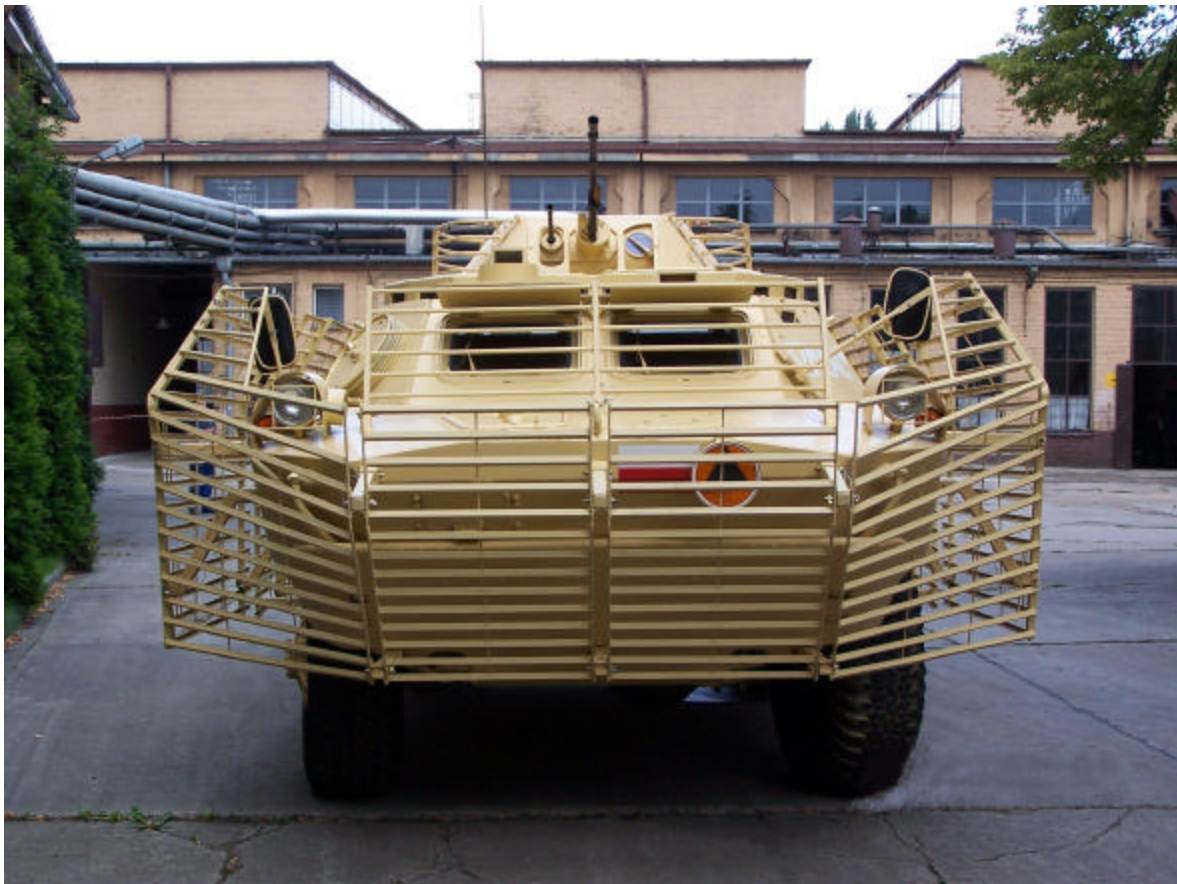
Vista frontal da blindagem “gaiola” desenvolvida pela empresa polonesa WZM e aplicada no veículo BRDM JACKAL 2M96iK + Crédito da foto: WZM
