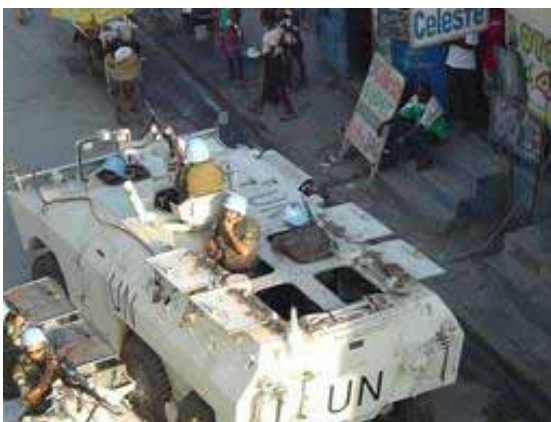
EE-11 Urutu com escotilhas abertas visto de cima de uma edificação e já com os sacos de areia ao redor das escotilhas. (Fotos: CComSEx)
