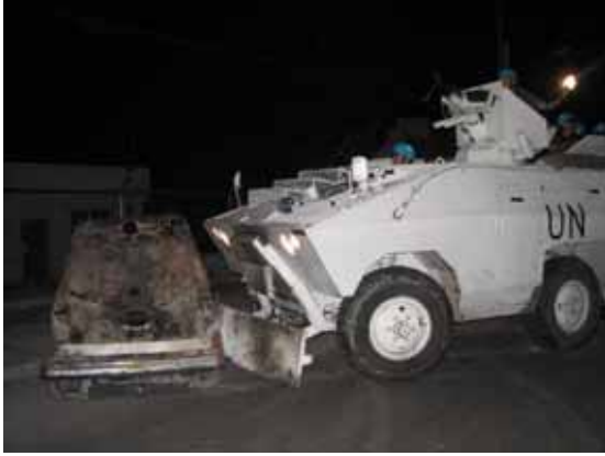
Detalhe do “bigode” removendo obstáculos e os sacos de areia na parte traseira do veículo servindo de anteparo para as escotilhas. (Fotos: CComSEx)
