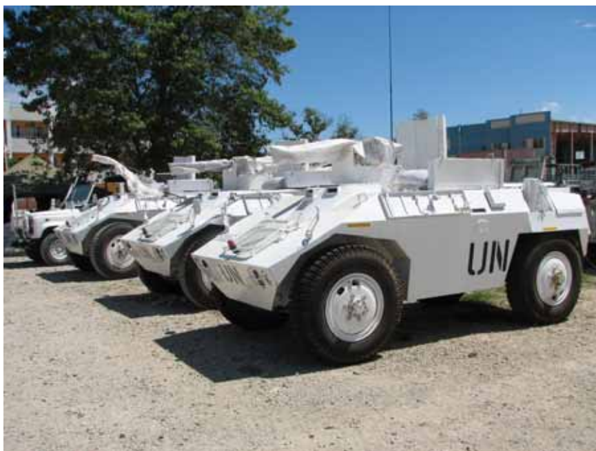
Três EE-3 Jararaca do Uruguai operando no Haiti. Notar as proteções lateral e traseira ao redor da torreta da metralhadora. (Foto: Sgt. Presoto)
