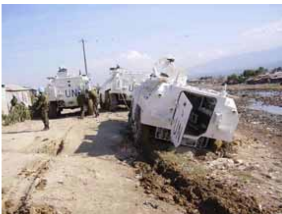
Dois momentos cruciais nas operações, atolamento e obstáculos nas ruas. Notar no veículo da direita as proteções lateral e frontal da torreta com metralhadora, bem acima do escapamento e logo atrás os sacos de areia. (Fotos: CComSEx)
