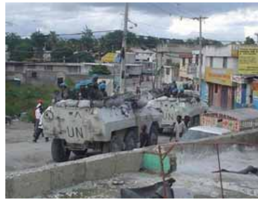
EE-11 Urutu com escotilhas abertas visto de cima de uma edificação e já com os sacos de areia ao redor das escotilhas. (Fotos: CComSEx)
