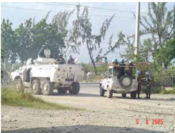
EE-11 Urutu Jordanianos em missão de patrulhamento. Notar os cubos de roda e o pneu. (Fotos: CComSEx)
