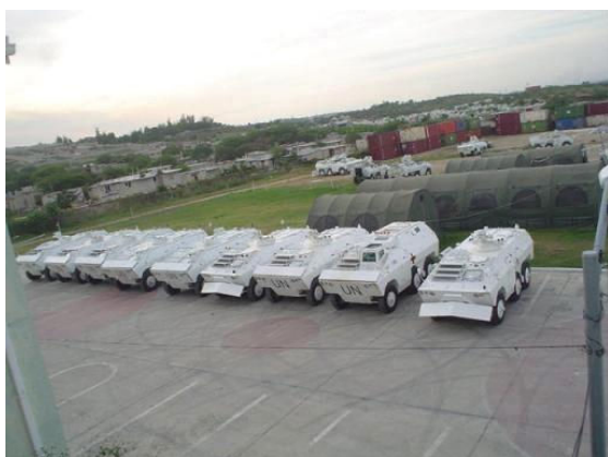
Blindados EE-11 Urutu do Exército Brasileiro no Haiti. Versão final do EE-11 Urutu em uso. Notar lâmina frontal, cobertura blindada para o motorista e torreta blindada. (Fotos: CComSEx)
