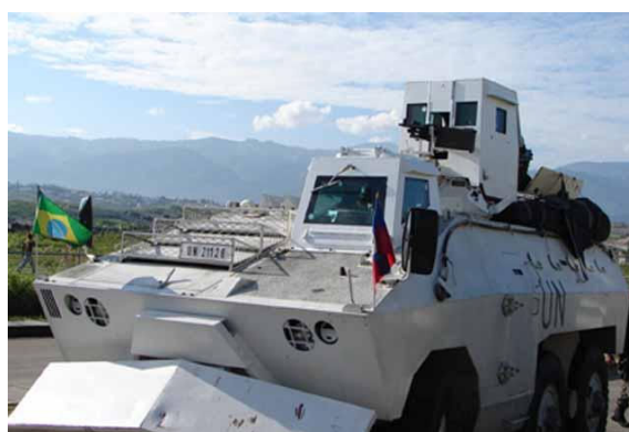
Blindados EE-11 Urutu do Exército Brasileiro no Haiti. Versão final do EE-11 Urutu em uso. Notar lâmina frontal, cobertura blindada para o motorista e torreta blindada. (Fotos: CComSEx)
