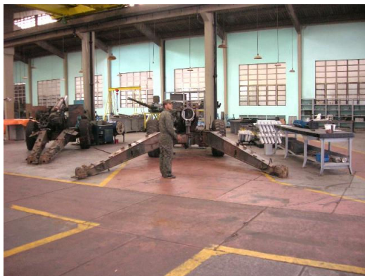
Manutenção de 4º escalão nos obuseiros 155 mm M-114 e mais recentemente no 105 mm M-56 Oto Melara , e confecção de redes de camuflagem. (Fotos: AGSP)
