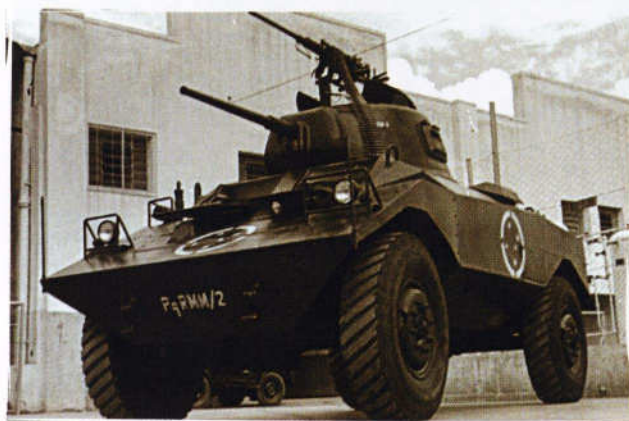
O VBB-1 totalmente armado e já sem o pneu estepe. Está equipada com quatro pneus PPB (Pneu à Prova de Balas) desenvolvidos pela Novatração em 1969
