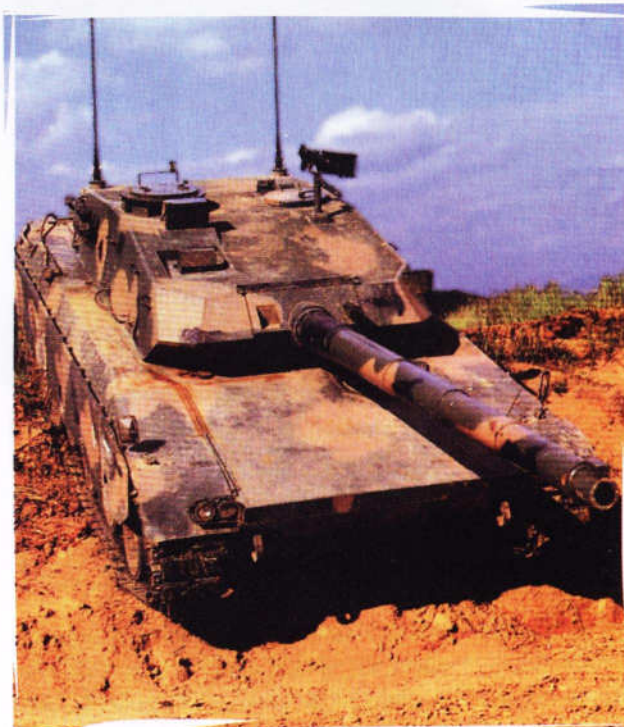
A primeira versão do Osório P.o. A torre e o canhão não são verdadeiros, apenas o chassi. Note a camuflagem na versão Exército Brasileiro
