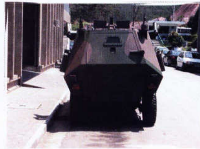
Vista traseira do protótipo totalmente pronto no pátio da Inbrafiltro. Note sua forma angulosa com a porta central
