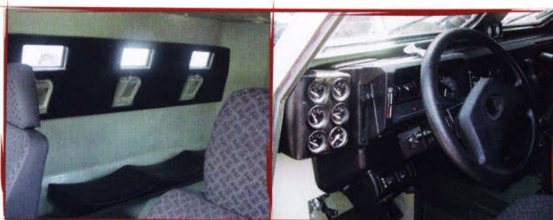
Detalhe do painel de instrumentos e compartimento do motorista no protótipo. Detalhe da parte interna – lateral traseira direita do veículo, seteiras e vidros à prova de balas
