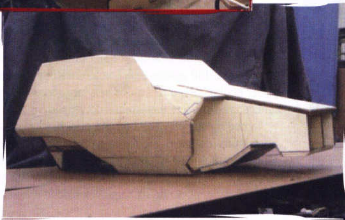
Construção de uma maquete na escala 1:5 que serviu de base para o futuro mock-up
