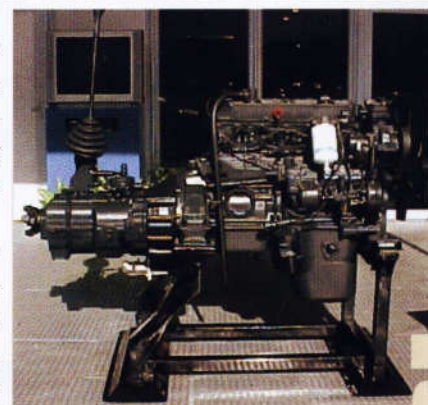
Motor Mercedes Benz OM 366LA diesel, similar ao usado pelo AV-VBL 4x4
