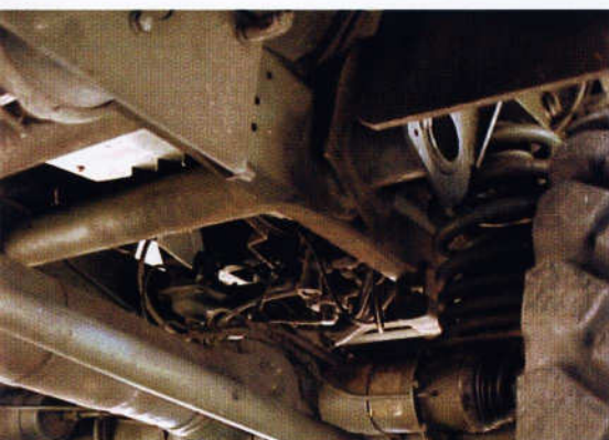
Detalhe do diferencial, eixo cardan e suspensão traseira do AV-VBL 4x4
