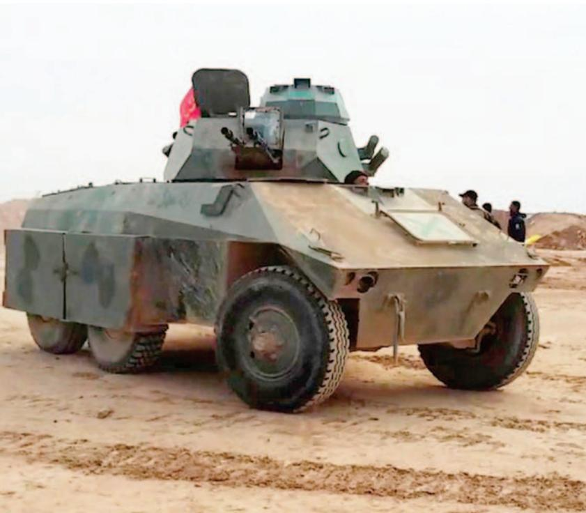
EE-9 Cascavel M4 da Brigada 26 Al Abbas (Iraque), utilizando saias laterais nas rodas traseira, metralhadora dupla ZPU-2 de fabricação russa e calibre 14,5 mm, no lugar do canhão Engesa EC-90 de 90 mm, operando na área de Mosul, em 23 de janeiro de 2017. (Crédito da foto: Iman Al-Holy Shrine)
